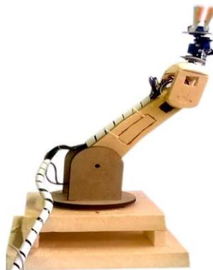
Figura 3 – Robô manipulador de 6 GDL.
