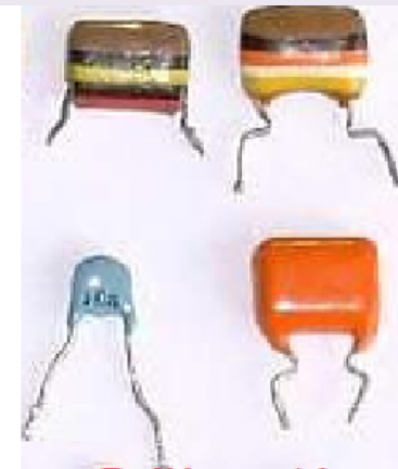
Poliéster (de aproximadamente 1\text{nF} até 1\mu\text{F} )
