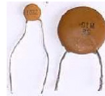
Cerâmica (valores baixos até cerca de 1\mu\text{F} )
