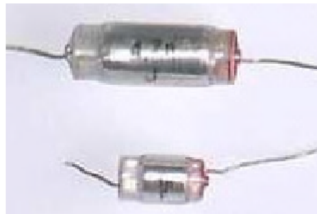
Poliestireno (geralmente na escala de pF)
