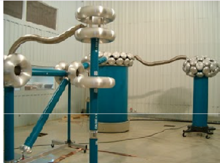
Capacitores de AT em ensaio de descargas parciais
