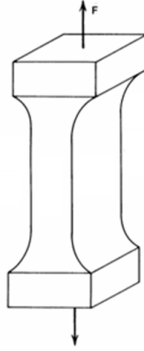
Fig.2. Corpo de prova onde os extensômetros serão instalados.
