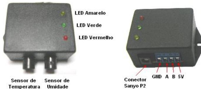
Figura 7. Vista externa dos terminais microcontrolados.
