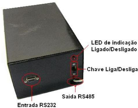
Figura 6. Vista externa do conversor RS232/RS485 em uma caixa metálica de 25x15x10 cm
