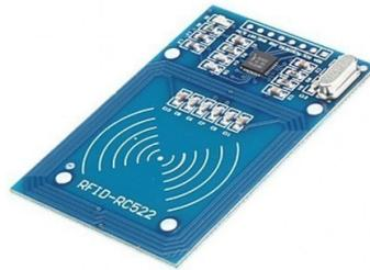
Figura 6 – Sensor RFID Mfrc522 de 12.56MHZ.
