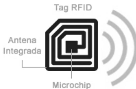
Figura 1 – Exemplo de circuito da tag RFID.
