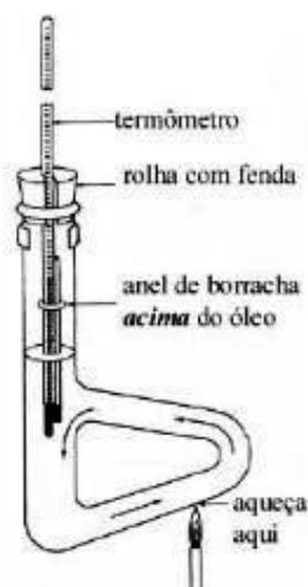
Figura 1. Montagem para determinação de temperatura de fusão.
