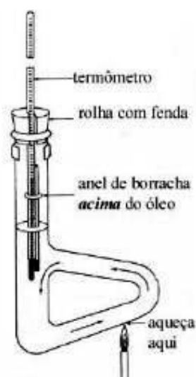
Figura 1. Montagem para determinação de temperatura de fusão.
