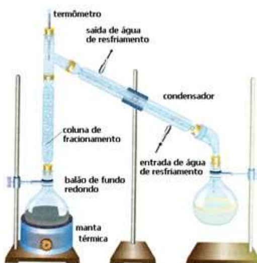
Figura 2. Aparelhagem de destilação fracionada.
