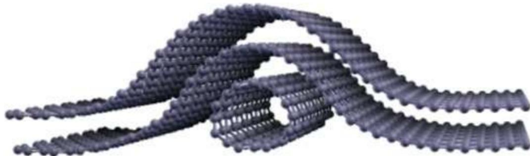
**Figura:** Dupla camada de grafeno depositada sobre uma rede de nanotubos de carbono.
