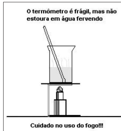
Figura 3. Material utilizado no experimento de ebulição da água.
