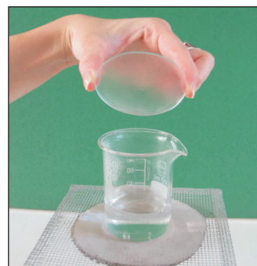
Figura 4: Observando o vapor de água condensado sobre uma placa de vidro.
